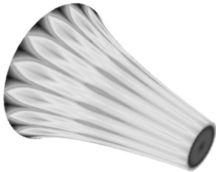
(b) 塞锥附近气流马赫数的模拟结果
